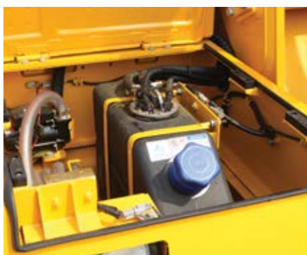
POMPA NAPEŁNIANIA PALIWA
